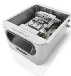
Držáky pro testování materiálů v tahu/tlaku v přístroji do 0,15 a 1 kN
